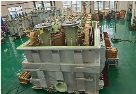
ZHSFPZ-20000110 Rectifier Transformer
