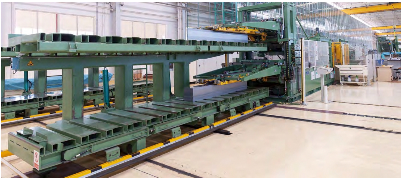
Transversal silicon sheet automatic cutting line Автоматическая линия резки поперечного силиконового листа
