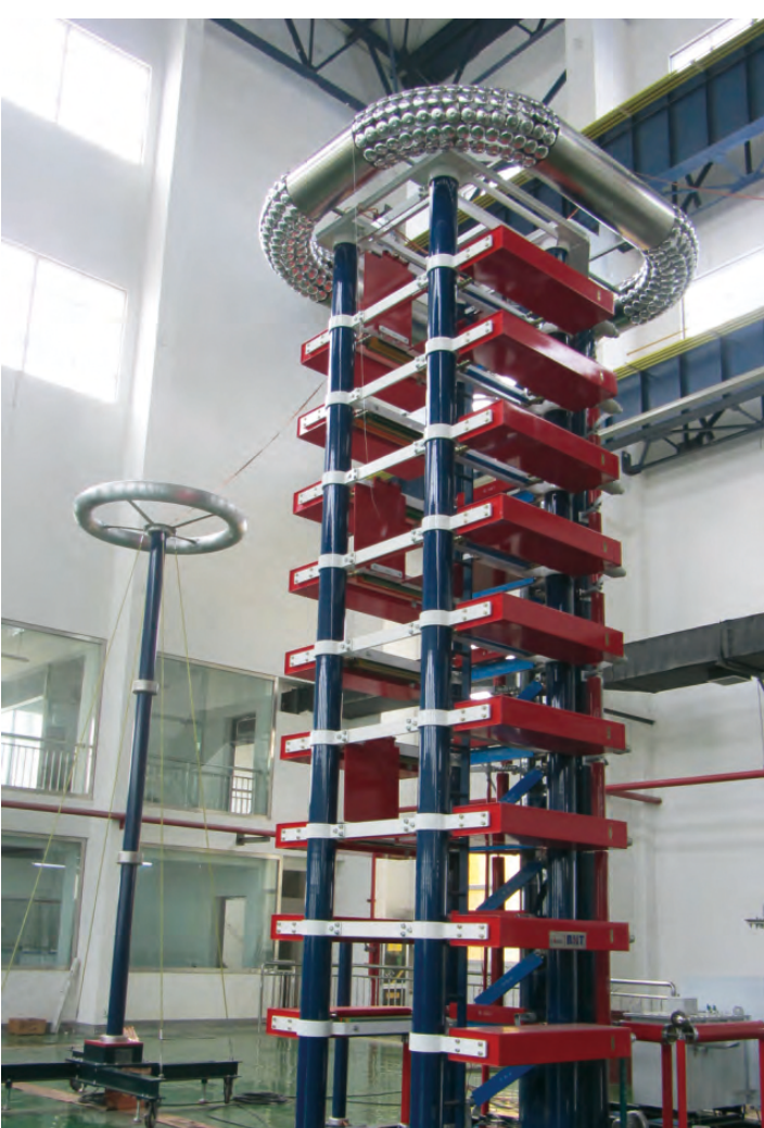
1800kV lightning pulse generator Генератор грозовых импульсов 1800 кВ.
